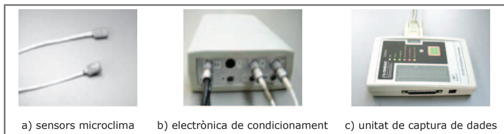
Figura 3.10. Sistema per al registre de les variables de microclima
