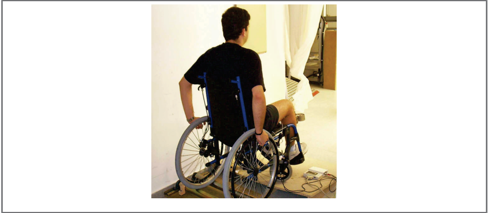
Figura 3.11. Usuario impulsándose sobre una estructura de rodillos durante el ensayo de microclima
