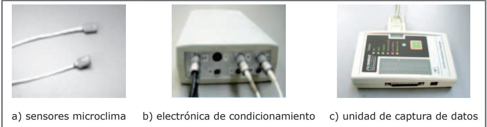
Figura 3.10. Sistema para el registro de las variables de microclima
